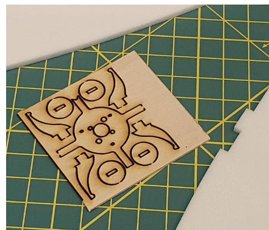
Ein paar Kleinteile müssen auf dem Laser oder von Hand aus Sperrholz hergestellt werden.
