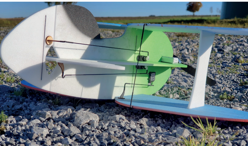
Detailaufnahme der Anlenkung: Ø1-mm-CFK-Stäbe werden mit Schrumpfschlauch an den Hörnern fixiert.
